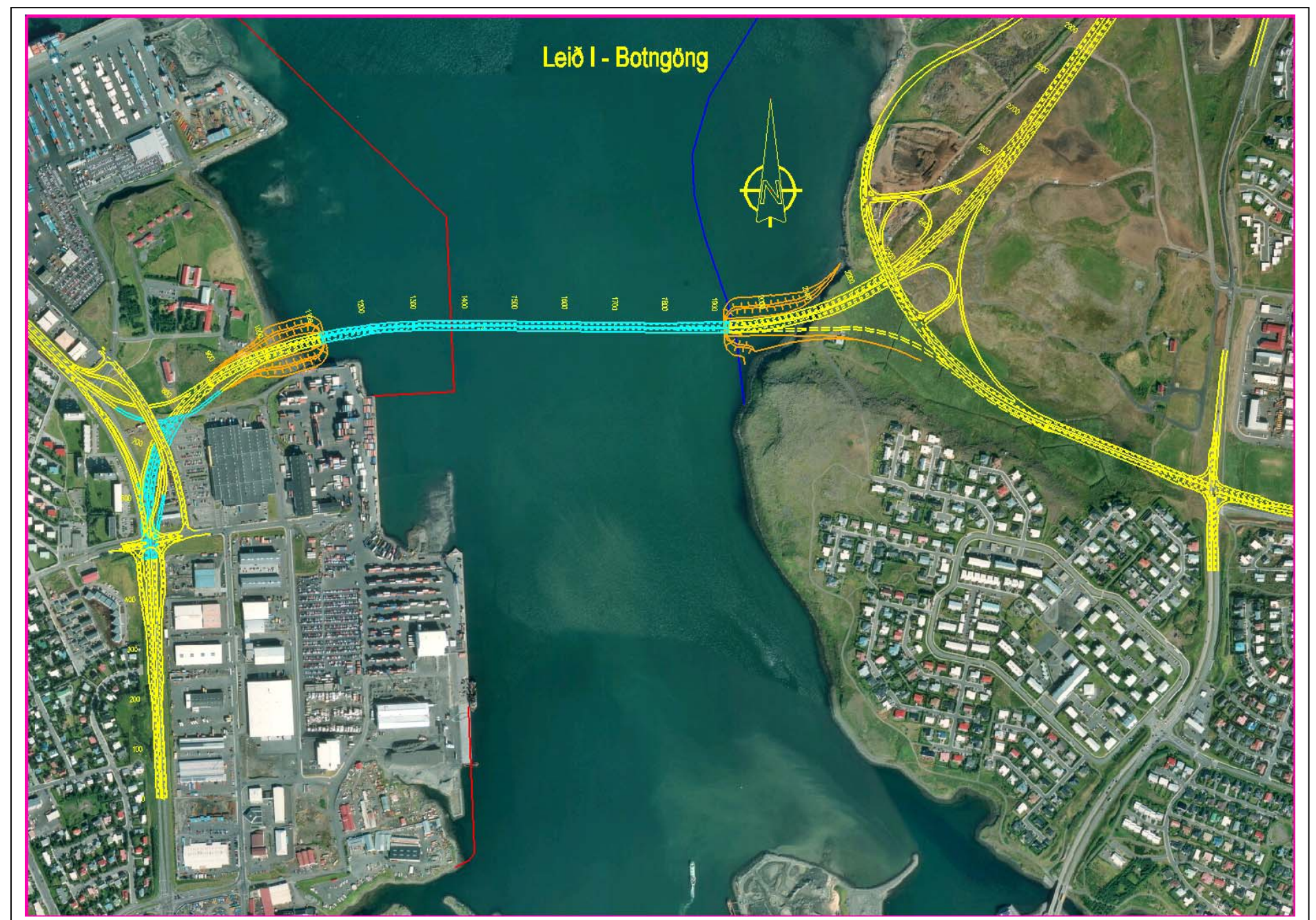
Mynd 5.1 Grunnmynd af legu botnganga undir Kleppsvík
