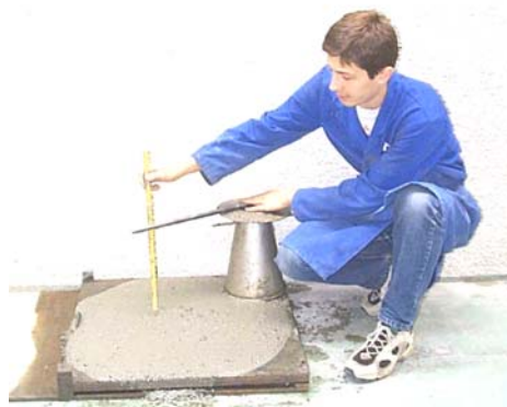
Mynd 1. Hér má sjá sigmál sjálfútleggjandi steinsteypu.
