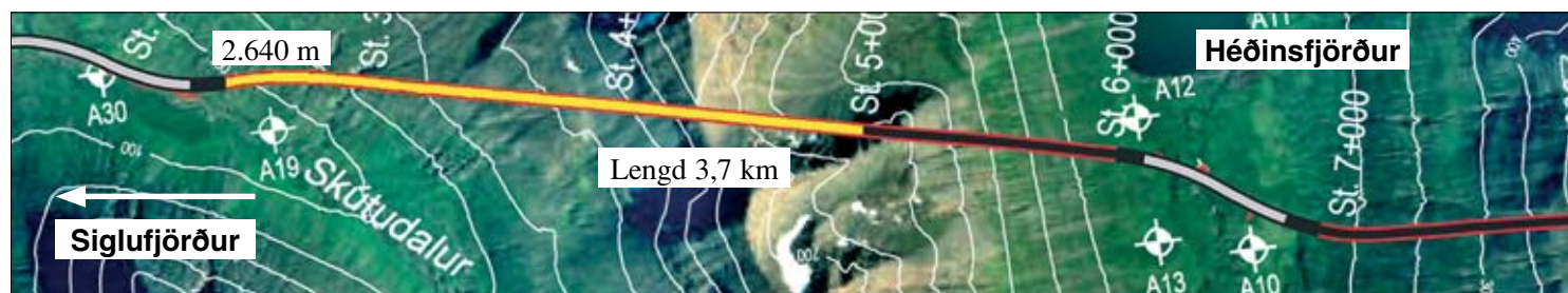
Staða framkvæmda við Héðinsfjarðargöng 22. okt. 2007. Búið er að sprengja 2.640 m í Siglufirði og 1.812 m í Ólafsfirði.
