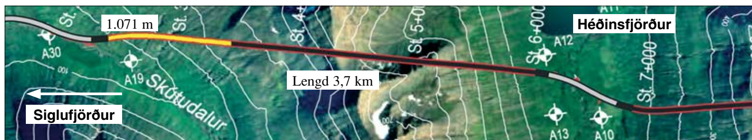
Staða framkvæmda við Héðinsfjarðargöng 12. mars 2007. Búið er að sprengja 1.071 m í Siglufirði og 874 m í Ólafsfirði.
