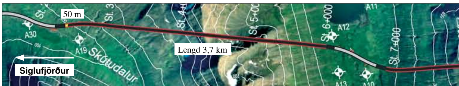
Staða framkvæmda við Héðinsfjarðargöng 1. október 2006. Samtals er búið að sprengja 50 m.
