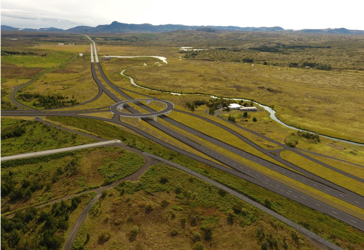
MYND 5.64 2. og 5. áfangi (tvöföldun vegar frá Norðlingavaði að Hólmsá, og mislæg vegamót við Hafravatnsveg, skv. aðalvalkosti). Efst er grunnteikning, þá ásýndarmyndir. Horft er til Suðausturs yfir vegamót við Hafravatnsveg. Efsta mynd sýnir núverandi ásýnd og mynd fyrir miðju ásýnd eftir 2. áfanga, þar sem einnig verður gert tvöfalt hringtorg í plani. Neðsta mynd sýnir ásýnd eftir 5. áfanga.
