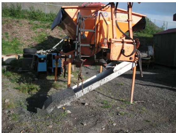
Sanddreifari með malarrennu til holuviðgerða.
