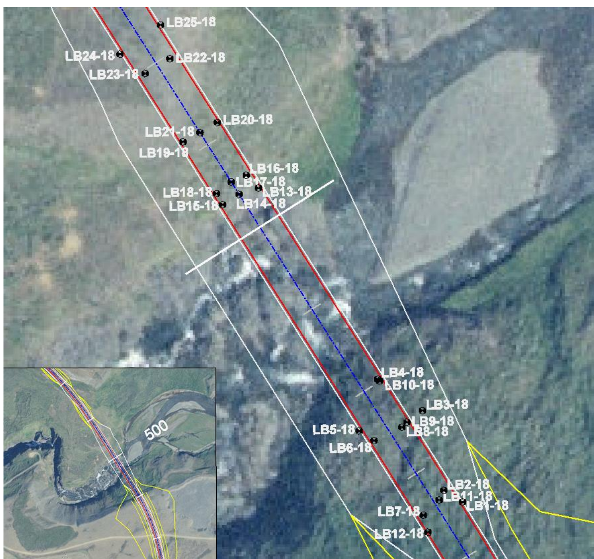
Mynd 16 - Staðsetning 25 borhola í brúarstæði við Laxá. Yfirlitsmynd yfir brúarstæðið í vinstra horni
