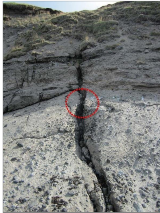
Mynd 9. Sprunga í fjörunni við Laugardal með stefnu NV-SA. Sjá hamar yfir sprungu (ljósmynd: GeoTek ehf, 2012).
