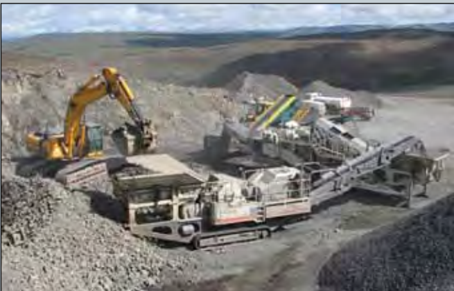
Færanleg samstæða: kjaftbrjótur (forbrjótur), kónbrjótur (eftirbrjótur) og tveggja dekkja harpa. Öll tækin eru á beltum.
